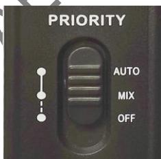
**AUTO** : Lors d'une transmission entrante, Bluetooth et Aux sont mis en sourdine. et reprennent après la fin de la transmission ;
